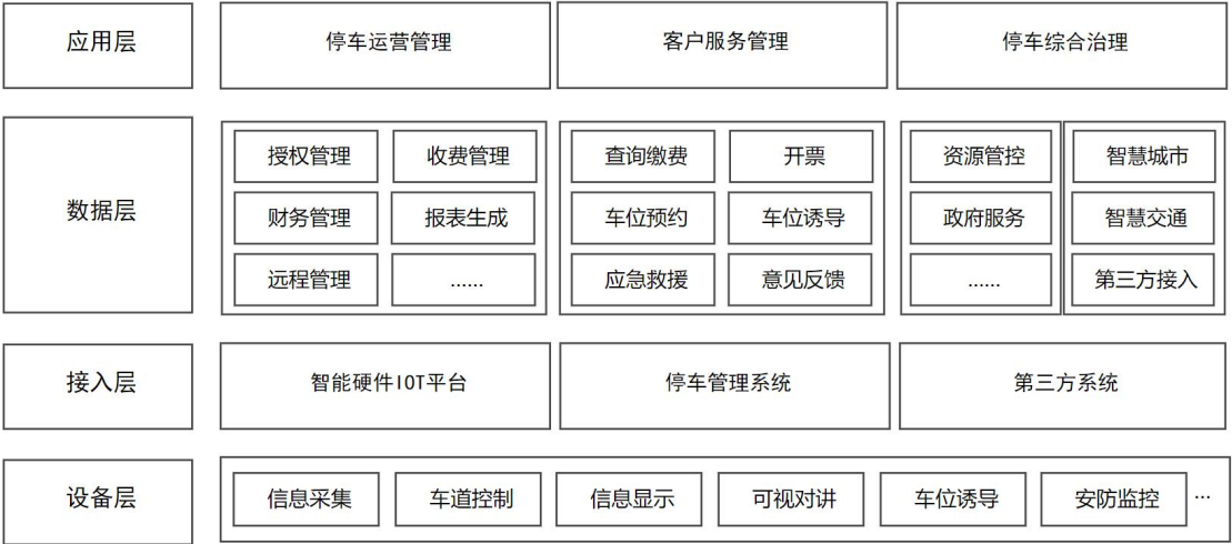
图 1 智慧停车管理系统构架图
