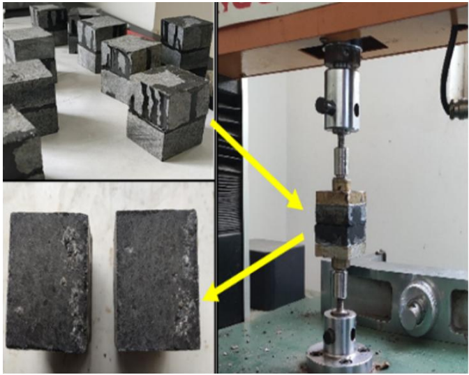
图 5 固化后聚氨酯界面拉拔强度试验
