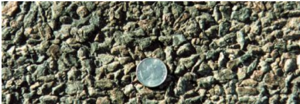
(3) 单一粒径的集料铺面状态
