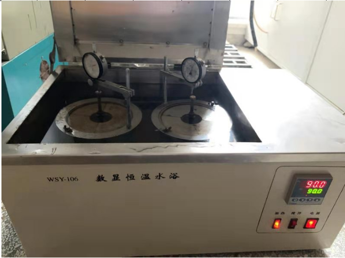
图 2 钢渣浸水膨胀率试验
