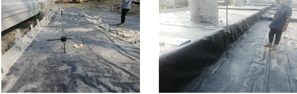
图 5 泡沫聚合土现场动力触探测试 (N10)
