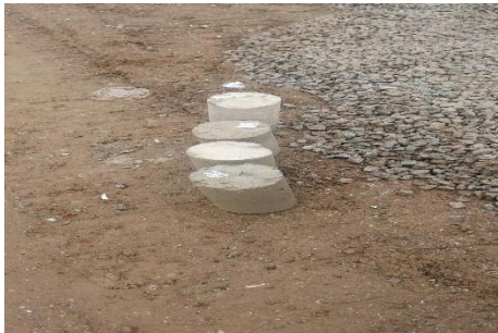
图 7 现场取芯芯样示意图
